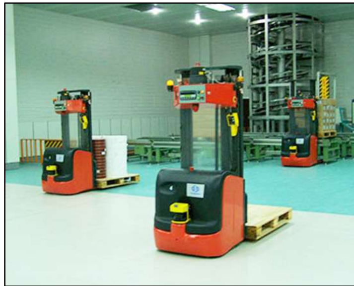
شكل ( 16 ) يوضح شكل الرافعة الحديثه التى تعمل بنظم الاستشعار و التحكم الذاتى .
